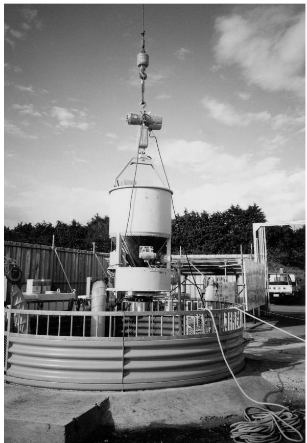
写真1. 1 遠心力吹付け機坑外吊り下げ状況
